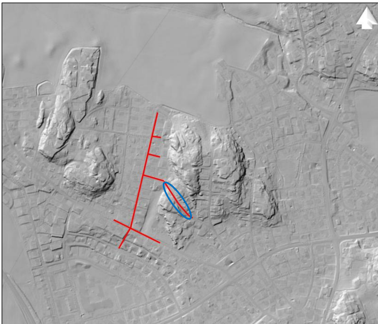
Figur 2-1: Skyggerelieff over området [6]. VA-anlegget er vist med røde streker. Aktuelt område for sprengning/pigging er innenfor blå ellipse.
